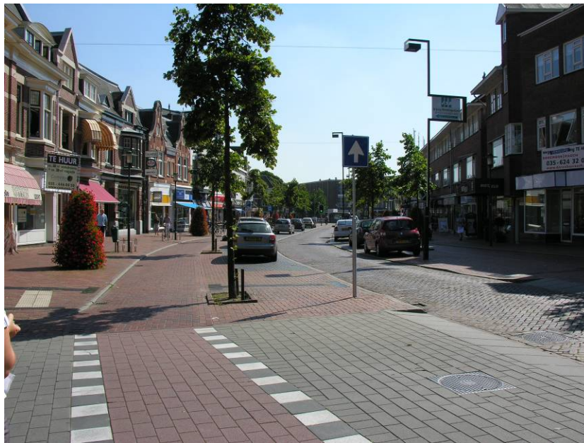
Fot. 4.9. Miejsca postojowe wyznaczone równoległe wzdłuż krawędzi drogi jednokierunkowej, wyraźnie wydzielone z powierzchni jezdni
