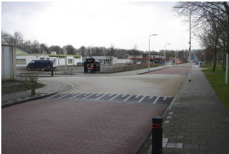
Fot. 4.16. Wyniesiona powierzchnia skrzyżowania w strefie „30”
