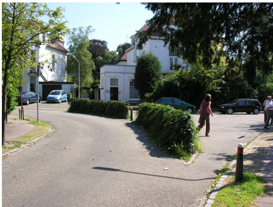
Fot. 4.13. Ograniczenie dostępności do obszaru pojazdom wielośladowym. Żywopłót kryje w sobie solidną konstrukcję metalową.
