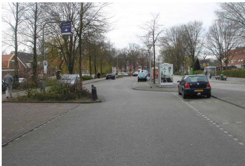
Fot. 4.7. Przykład prowadzenia osi drogi linią „esową”
